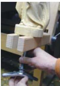
4. Drehen Sie nun die Flügelmutter auf die Schraube auf und ziehen diese fest an!
