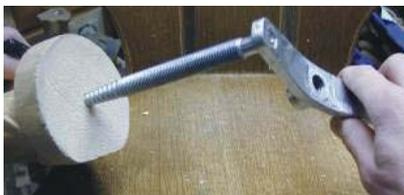
2. Drehen Sie nun das Holzgewinde Ihrer Figureschraube so weit als möglich in das Bohrloch ein. Achten Sie darauf das Sie beim Eindrehen genügend Druck ausüben damit das Gewinde auch schön in das Holz "eingreift".
